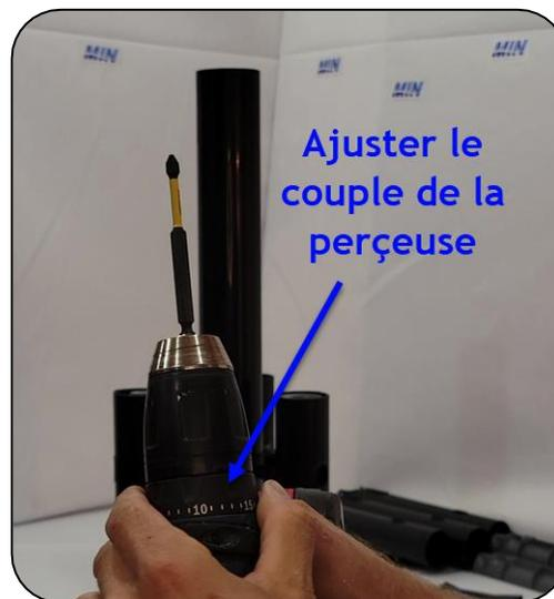
**9.** Prendre les vis 1.5'' avec les rondelles d'acier inoxydable insérées préalablement. Pointer vers le haut et incliner l'assemblage pour que la vis reste en place sur la perceuse. Regarder à l'intérieur du tube pour aligner la vis dans le trou et visser jusqu'à ce que les pièces soient accotées ensemble. Au besoin, remonter la tension.
