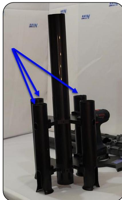
7. Insérer les pièces grises dans les tubes en alignant l'encoche vers la fin.
